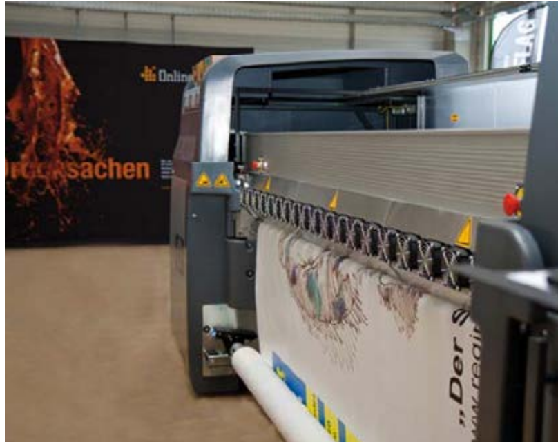
DIE HP SCITEX LX600 bedruckt PVC-Planen und Meshgewebe mit geruchsneutralen Latexfarben.
