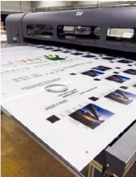
DIE HP SCITEX LX600 bedruckt PVC-Planen und Meshgewebe mit geruchsneutralen Latexfarben.
